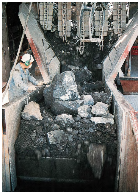
Abbildung 6.85: Gebrochene Festgesteine. Abbau im Steinbruch durch Grosssprengungen (Steinbruch Zingel).
