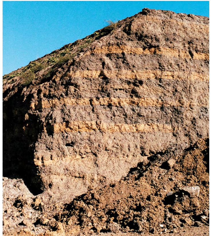
Abbildung 3.31: Zwischendepot von Opalinuston in der Grube «Cheesleten» in Frick AG; lagenweiser Aufbau mit braunem (verwittertem) und schwarzem (unverwittertem) Material.
