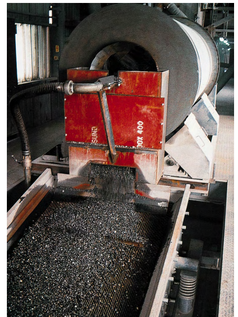
Abbildung 6.87: Gebrochene Festgesteine. Brecher zur Splitttherstellung.
